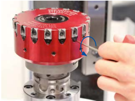
1. Com uma chave Allen tamanho 2,5 girar o fuso de rosca uma volta no sentido anti-horário.
