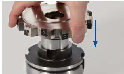
5. Encaixar a ferramenta de modo plano sobre o mandril porta-fresas de encaixe.
