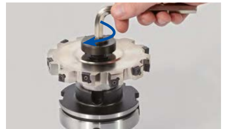
8. Continuar a enroscar o parafuso de aperto da fresa no sentido horário com auxílio de uma chave Allen e, em seguida, apertar com um torquímetro (torque de aperto ver tabela "Torque de aperto para parafuso de aperto da fresa").
