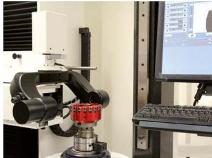
5. Mit dem Einstellgerät optisch einen Fräseinsatz  $-0,01$  mm vor Einstellmaß EM einstellen: Hierzu mit der optischen Messeinrichtung die Schneidkante erfassen und die Gewindespindel mit einem Innensechskantschlüssel im Uhrzeigersinn drehen bis  $EM = -0,01$  mm erreicht ist. Für eine rein optische Einstellung dieses Vorgehen für die restlichen Fräseinsätze wiederholen (anschließend weiter mit Schritt 7).
