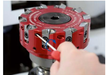
6. Die Sicherungsschraube bis zum Anschlag mit einem Innensechskantschlüssel im Uhrzeigersinn eindrehen und anschließend eine halbe Umdrehung zurückdrehen.
