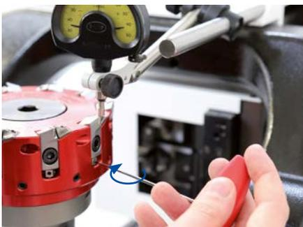
10. Entweder mit dem Einstellgerät optisch oder taktil per Messuhr den Fräseinsatz mit der höchststehenden Schneidkante ermitteln und abnullen. Anschließend alle Fräseinsätze optisch oder per Messuhr zur höchststehenden Schneidkante einstellen:
