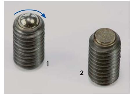
3. Prüfen ob die flache Seite der Sicherungsschraube (2) in Richtung Sitz des Fräseinsatzes zeigt. Falls eine Kugelform erkennbar ist (1), diese mit dem Finger auf die flache Position drehen.
