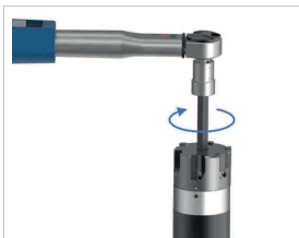
Abb. 12: Gewindespindel mit Anzugsdrehmoment anziehen
