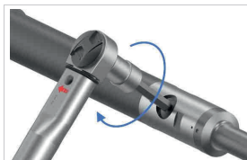
Abb. 16: Spannbolzen mit Anzugsdrehmoment anziehen
