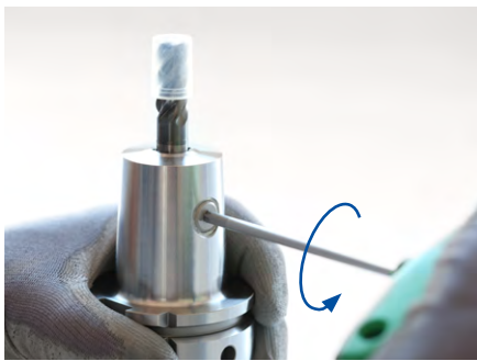
1. 以逆时针旋转松开夹紧螺钉。
