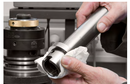
3. 仔细清洁测试样棒或刀具的锥体和平面。装入测试样棒或刀具。
